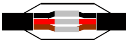
Emenda resinada com molde
